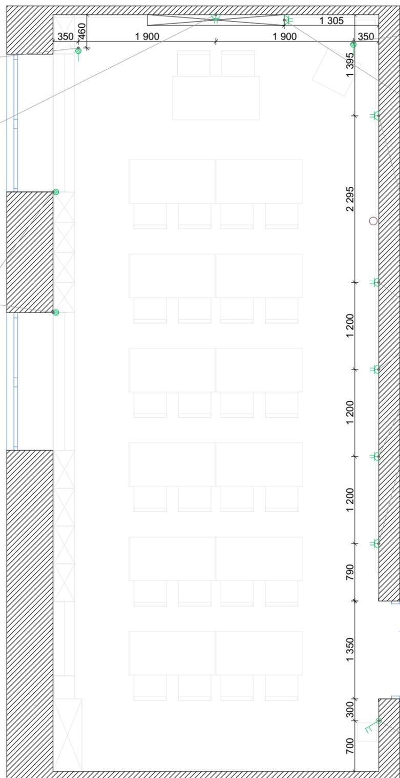
Электровывод для подключения встроенной аудиосистемы (h = 3500)
