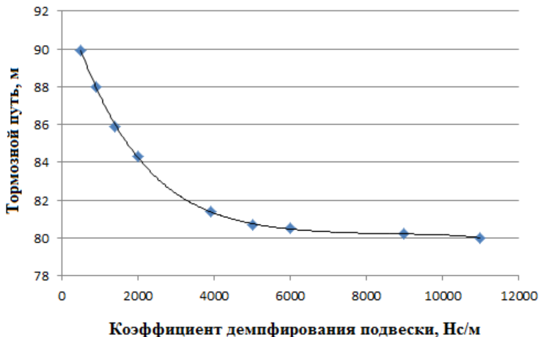
Рис. 6.6. Пример результата расчета тормозного пути автомобиля с функционирующей ABS от коэффициента демпфирования элементов подвески
