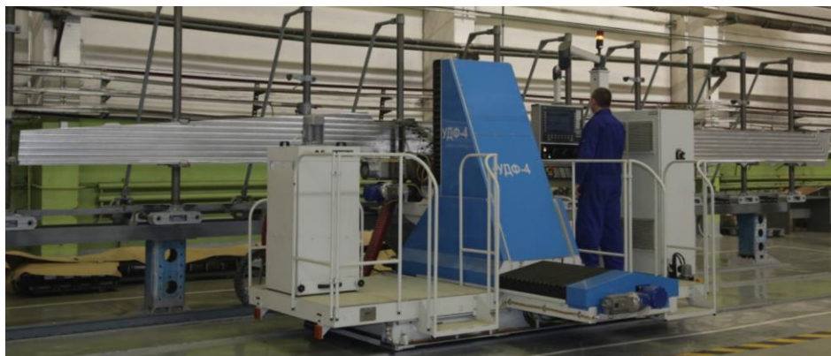
Установка для дробеударного формообразования и зачистки УДФ-4
