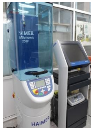
Балансировочная машина Haimer TD Comfort Plus
