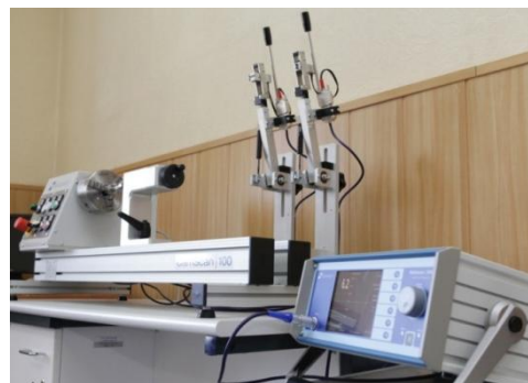
Цифровой анализатор шумов Баркгаузена Rollscan 300
