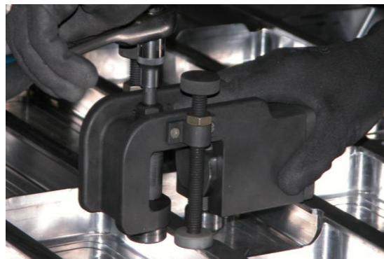
Комплекс оборудования для формообразования и правки раскаткой роликами
