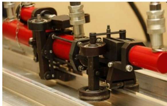
Комплекс оборудования для формообразования и правки раскаткой роликами
