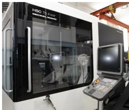
Фрезерный обрабатывающий центр HSC75V linear
