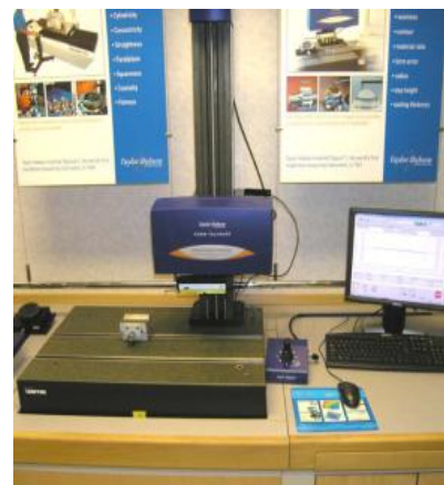
Прибор для измерения шероховатости Taylor Hobson Form
