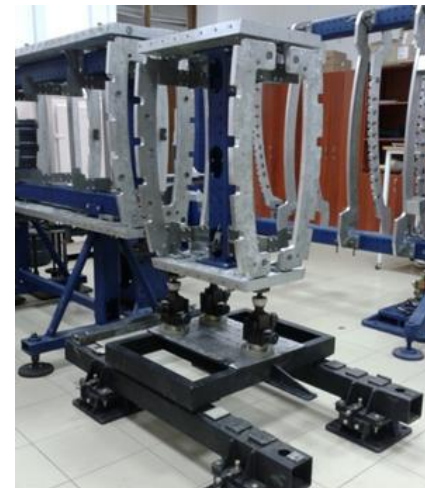
Лабораторные станды для узловой и агрегатной сборки и стыковки изделий авиационной техники
