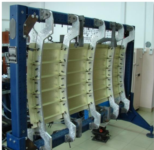
Лабораторные станды для узловой и агрегатной сборки и стыковки изделий авиационной техники
