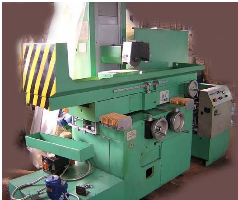
Универсальный плоскошлифовальный станок 3E711B
