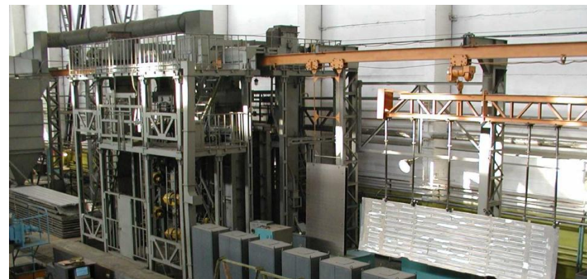
Установка дробеметная программная УДП-2-2,5
