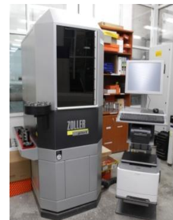
Прибор для измерения инструмента Zoller Genius III
